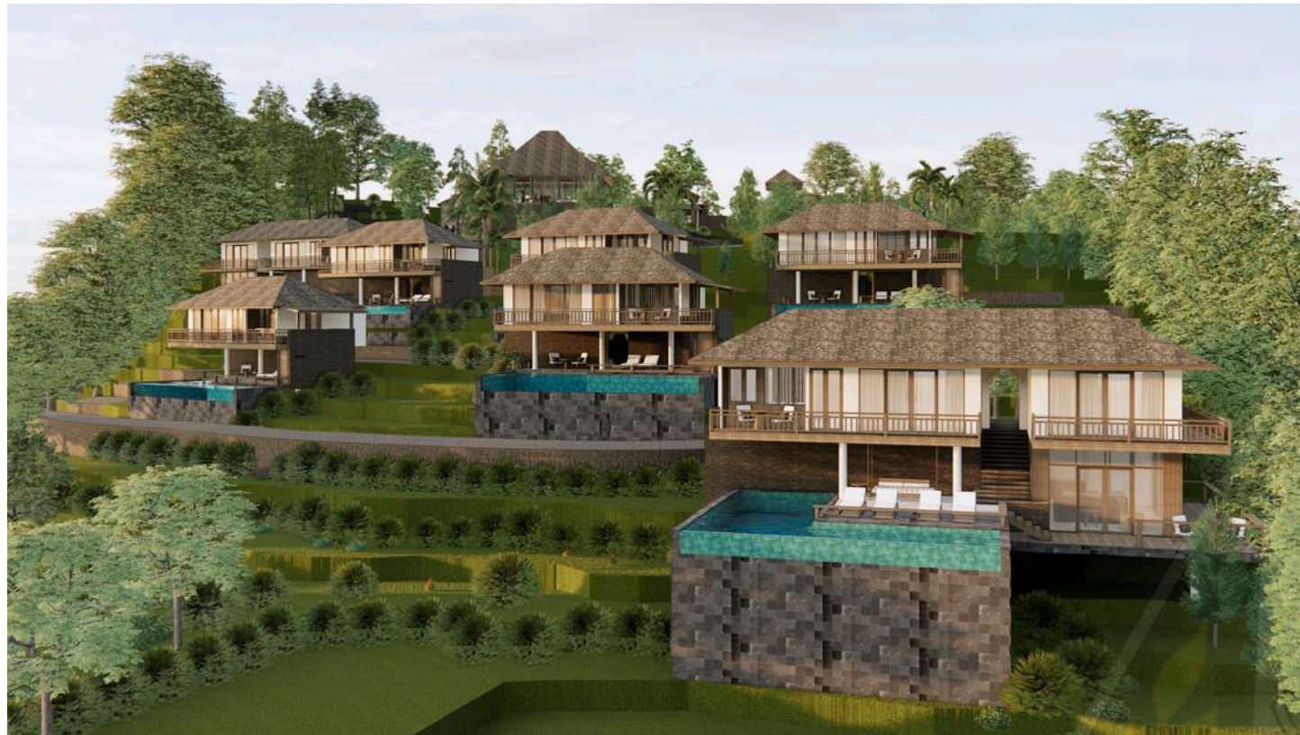
TAMPAK DEPAN KAWASAN, BENTUK PENATAAN MASSA MENGANUT KONSEP SUBAK (SAWAH BERUNDAK/ TERASERING) DAN MEMPERTAHANKAN KONTUR EKSISTING
