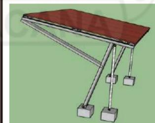
Bagian selasar menggunakan struktur dari hollow dengan satu kolom miring dan di tahan dengan kawat seling.
