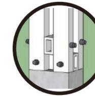
Keempat kolom digabungkan dengan bagian tengah dibatasi hollow digabungkan dengan baut.
