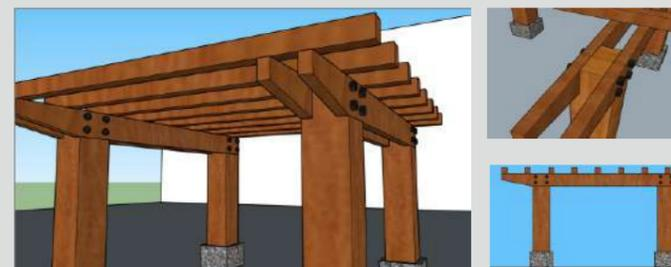
Struktur menggunakan kayu penggabungan kolom dan balok induk dengan cara kolom ditata bagian pinggir kemudian jepit dengan 2 balok dan dibaut. bagian atas balok sebagai struktur lantai dan balok pengikat. Dengan tidak adanya pembatas di sisinya melambangkan sikap terbuka bagi siapa yang ingin datang, struktur dengan kolom besar digabungkan bertumpuk dan dijepit bermakna mengayomi dan saling membantu.
