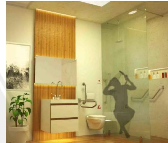
toilet dengan ukuran standar universal design, dengan kebutuhan peralatan hand railing pada bagian area closet, hand railing bagian area mandi, dan ukuran closet serta wastafel yang sesuai dengan standar ukuran universal design.
