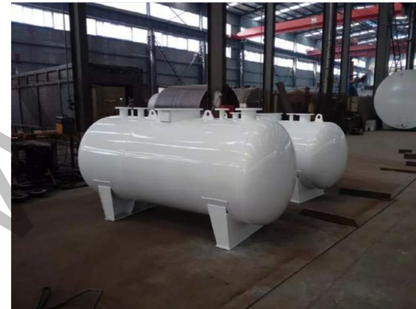
Tangki penyimpanan oli bekas
