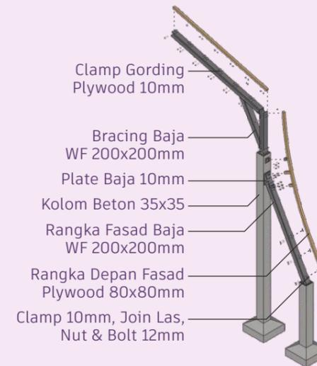
Terletak di sekeliling pusat bangunan, bertujuan sebagai barrier sekaligus agar limpasan air hujan tidak dapat masuk dari pinggir bangunan. Fasad dapat tertutup atau semi-terbuka.
