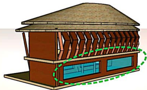
JENDELA : Diletakkan disisi Barat dengan bukaan besar untuk melihat view pemandangan kota
