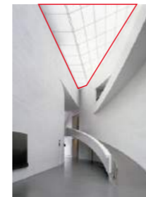
Contoh desain ramp tanpa bukaan namun menggunakan pencahayaan alami dari glass roof
