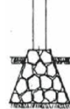
pondasi batu kali yang di ekspos. pondasi baru kali ini sudah cukup menahan beban. pondasi batu kali ekspos mengadopsi ciri khas rumah tradisional sumba
