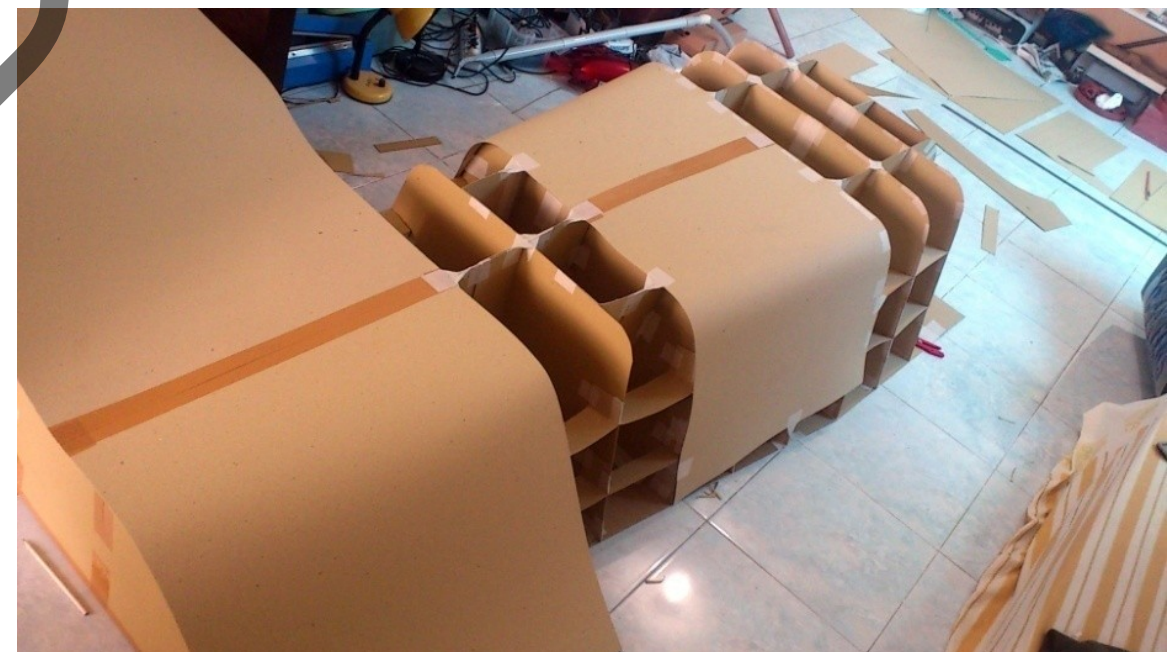
Gambar 5.4: Susuna Rangka Kemudian Ditutup Dengan Lembaran Karton
