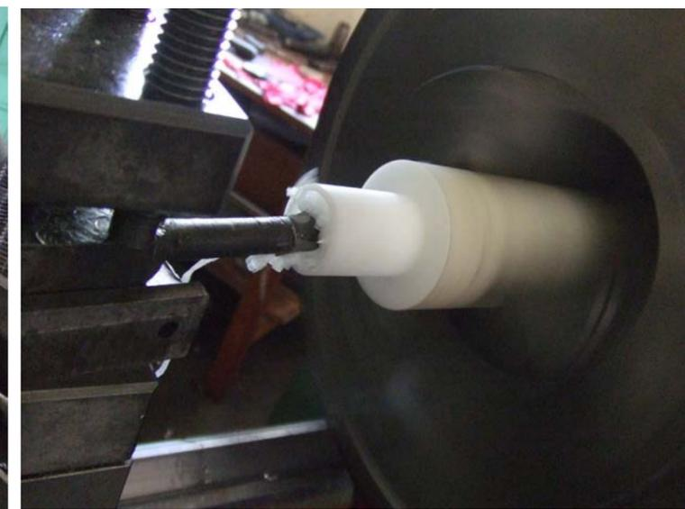
Gambar10. pembuatan tutup atas tabung
