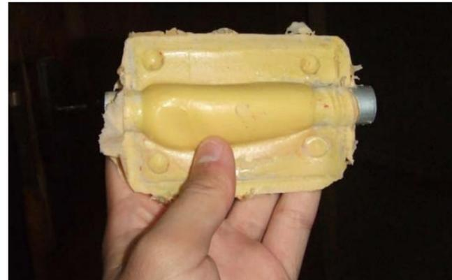
Gambar 6. Hasil cetak silicon
