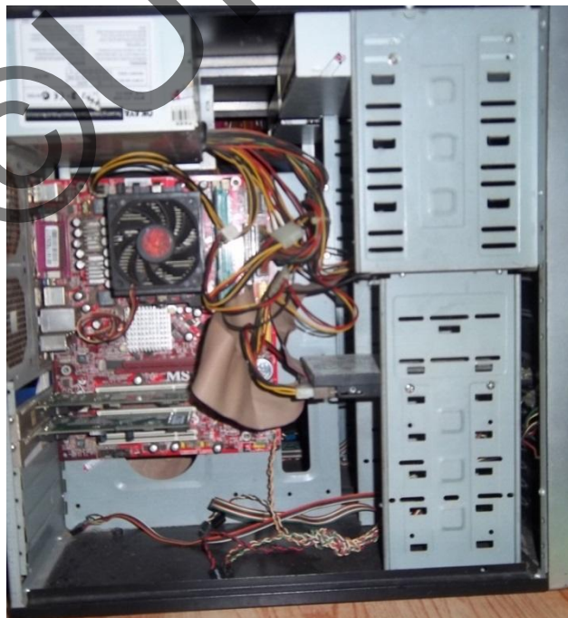
Gambar 3.5 PC yang digunakan sebagai router 2
