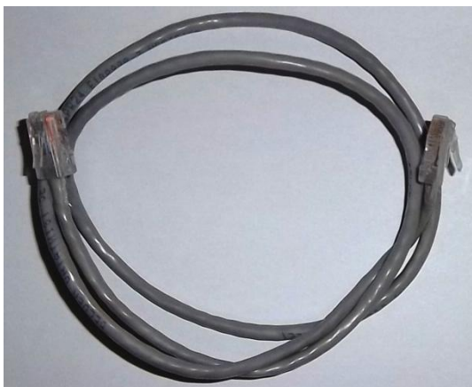
Gambar 3.10 Kabel RJ45 yang digunakan untuk menghubungkan setiap node
