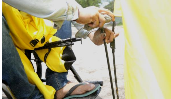
Gambar 5.5 Uji coba pemasangan pasak
