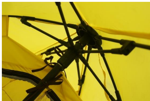
Gambar 5.2 Mekanisme geser ( sliding ) pada tenda
