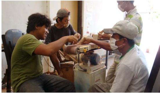
Gambar 5. Kenyataan yang terjadi ketika mengamplas, menggunakan tangan 1.
