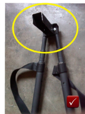
Penggantian kepala engsel karena faktor kekuatan dan keseimbangan
