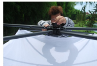
Memasang tiang X ke tiang penggantung
