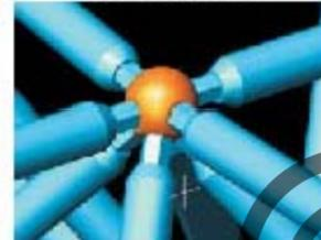
Struktur atap menggunakan struktur space frame dengan ball joint sebagai pengikat antar struktur, menggunakan space frame karena membutuhkan ruang besar tanpa kolom sebagai area auditorium.
