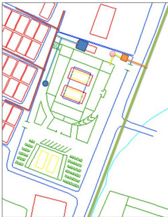
Air bersih menggunakan PDAM dan sumur yang ditampung dalam bak penampungan dan disalurkan melalui pipa-pipa. Air hujan disalurkan melalui saluran-saluran terbuka, kemudian dialirkan ke riol kota. Sedangkan air kotor disalurkan ke bak penampungan atau sumur peresapan.
