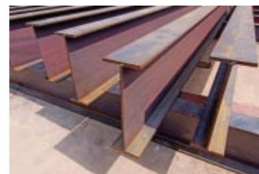
Struktur utama menggunakan baja IWF
