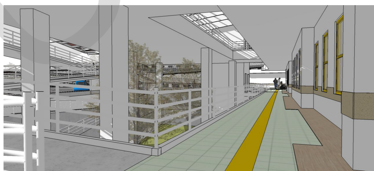
7. Suasana pada selasar ruang pengelola, cahaya yang diteruskan dari kantilever di lantai 2 memaksimalkan cahaya yang masuk, sekaligus menjadikan ruang interaksi baru dari teras lantai 2 dan selasar di lantai 1
